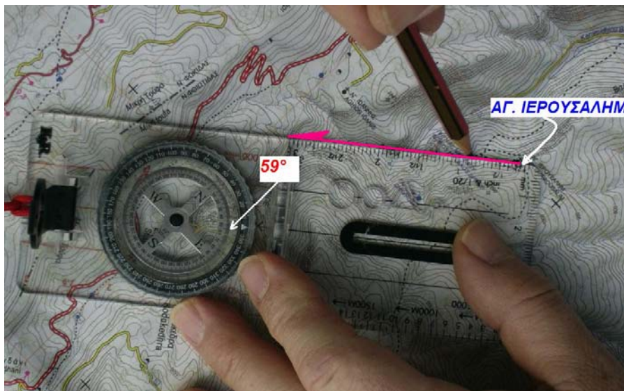
Σχ. Γ-12: Πώς χαράζουμε το αζιμούθιο (διόπτυση) στο χάρτη.
